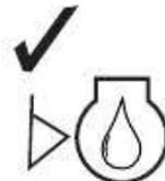
Carga de combustible. El motor no funciona con gasolina comercializada como E85 (con un 85% de etanol).
